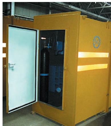
Пункт переключения в резервные самоспасатели становится единственным местом под землей, где шахтеры могут сохранить свои жизни после взрыва или пожара
