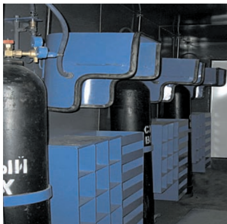
Пункт переключения в резервные самоспасатели становится единственным местом под землей, где шахтеры могут сохранить свои жизни после взрыва или пожара
