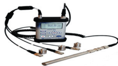
Рисунок 2. Прибор для анализа спектра вибрации и шума SVAN-958
