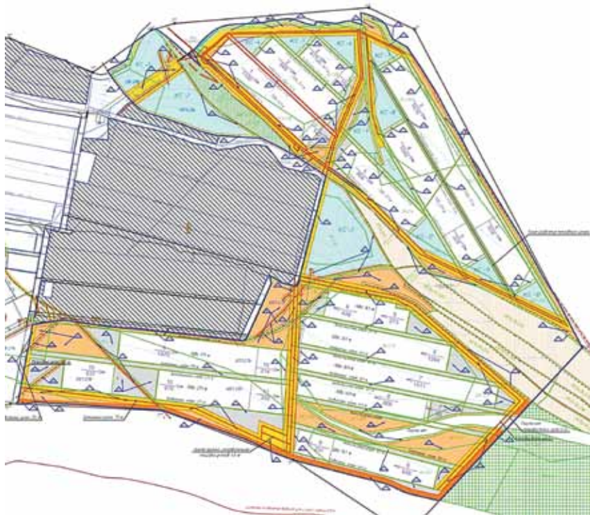
Рис. 1. Пласт «Мощный» — вскрытие, подготовка и совместная отработка запасов угля юго-западного блока горизонта -140 м и горизонта -350 м
